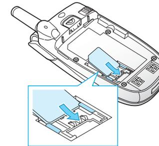
**Remarque :** pour retirer la carte, dégagez-la avec précaution du dispositif de fixation dans le sens indiqué par la flèche.
