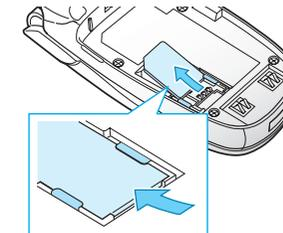
4. Remplacez la batterie de sorte que les languettes de cette dernière s'alignent sur les encoches situées au bas du téléphone.
