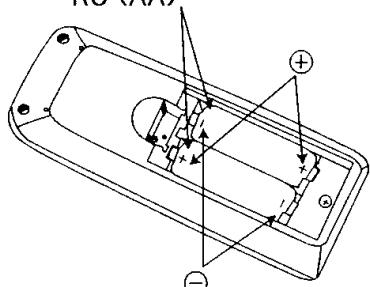
**Батарейки:** Используйте две батарейки размера “R6 (AA)”. Установите батарейки соблюдая полярность. В этом Вам помогут знаки “+” и “-” как на батарейках, так и на отсеке для батареек.
