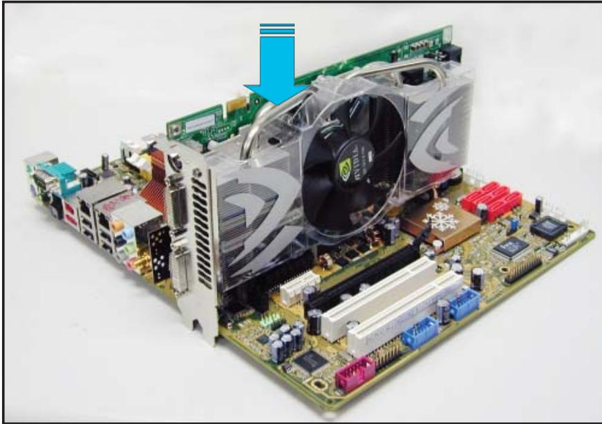
4. Stecken Sie die zweite Grafikkarte in den anderen Steckplatz. Vergewissern Sie sich, dass die Karte korrekt eingesteckt ist.
