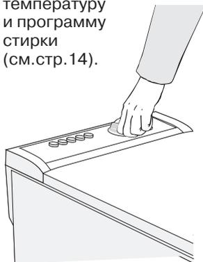
6. С помощью различных кнопок, установите другие возможные режимы и параметры стирки. Нажмите на главный выключатель для того, чтобы запустить машину (см. стр. 10).
