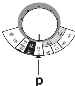
Данный селектор обеспечивает ввод программы / желаемой температуры стирки. Для этого поверните регулятор до совпадения (его номера или символа) с индикатором программы (p). Подбор температуры будет зависеть от характера избранной Вами программы.
