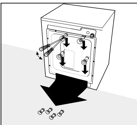
Для транспортировки качающейся узел машины зафиксирован 4 распорками на винтах. Перед тем как приступить к использованию машины, открутите блокировочные винты ключом.
