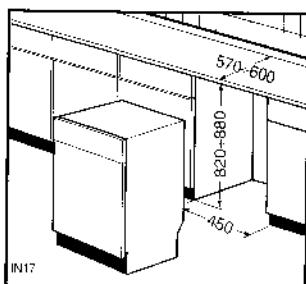
Машина не требует каких-либо дополнительных вентиляционных отверстий. Отверстия требуются только для шлангов и кабеля питания.
