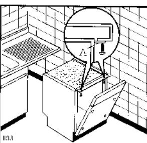
**ВНИМАНИЕ:** в случае крепления машины к кухонному элементу ни в коем случае не сверлите отверстий в боковых панелях машины, так как это приведёт к повреждению деталей, находящихся между корпусом и баком машины. Перед прикосновением к внутренним деталям машины вилку следует обязательно вынуть из розетки.
