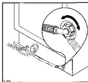
Прилагающийся к машине фильтр (A) следует установить изображённым на рисунке образом.
