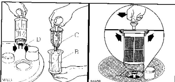
Для того чтобы снять фильтры (B) и (C), поднимите наружный фильтр (B) за имеющуюся в его центральной части воронку. Малый фильтр (C) снимается после этого посредством нажатия на два язычка (D).
