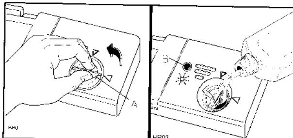
Плотно заверните пробку после каждого заполнения. Для того чтобы в процессе следующей за заполнением мойки не образовывалось пены, возможные остатки средства для полоскания, пролившиеся рядом с заполнительным отверстием, следует тщательно вытереть.
