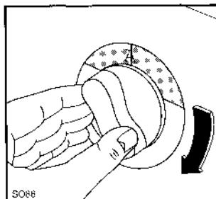
Поверните регулятор выбора программы по часовой стрелке таким образом, чтобы буква, соответствующая программе мойки, совпала с указателем выбранной программы.
