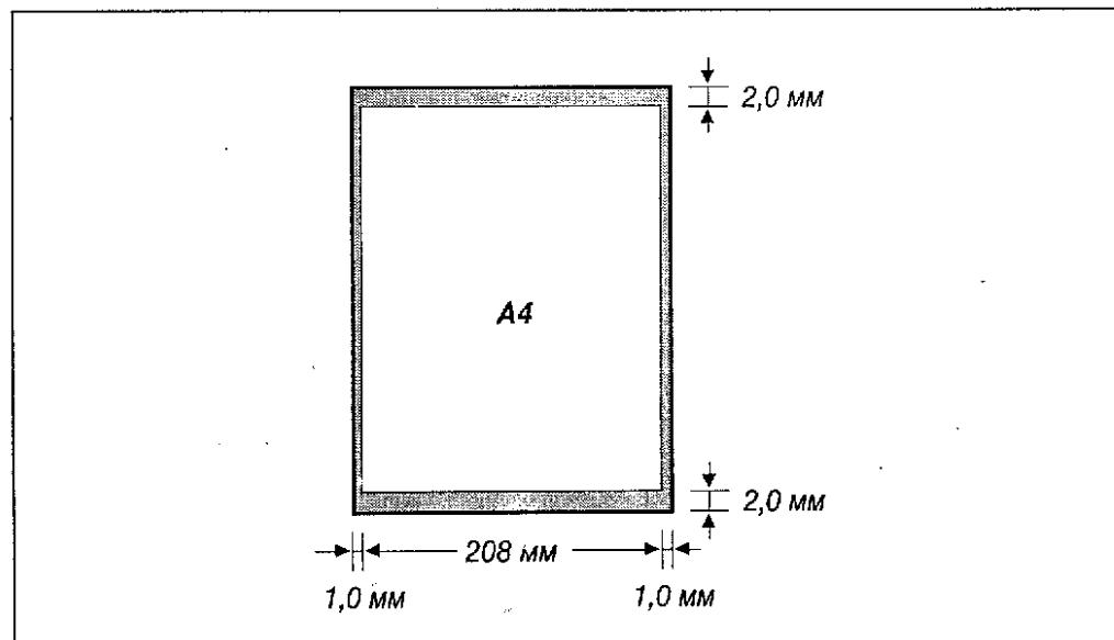
По обеим сторонам листа имеются поля шириной 1,0 мм, а сверху и снизу – по 2,0 мм, которые сканер не считывает.
