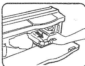
4 Отсоедините и снимите блок проявления, приподнимая его за зеленый ремешок.
