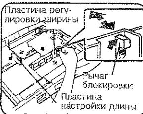
**3** Для того, чтобы загрузить бумагу, отличающуюся по формату, отожмите рычаг блокировки и передвиньте две пластины регулировки ширины. Затем передвиньте пластину настройки длины в положение, содержащее метку нужного вам формата бумаги.
