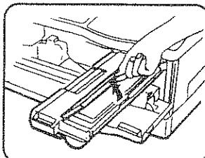
**3** Откройте крышку устройства для загрузки тонера.
