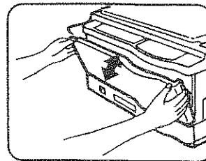
**2** Откройте и закройте переднюю крышку Копировального Аппарата для того, чтобы отключить индикатор сбоя подачи.
