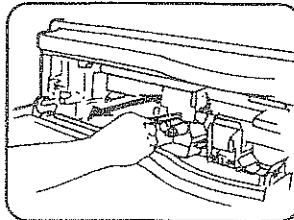
2 Передвигните встроенный очиститель узла коронного разряда несколько раз туда и обратно.
