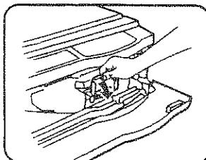
**2** Потяните вниз рычаг блокировки блока проявления и медленно вытягивайте блок проявления до тех пор, пока он не остановится.
