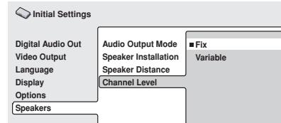
Если выбрана установка **Fix**, уровень каждого из 5.1 канальных аналоговых выходов фиксирован. Выберите установку **Variable** в том случае, если вы хотите отрегулировать относительный уровень таким образом, чтобы звуковое окружение больше соответствовало вашей комнате для прослушивания.
