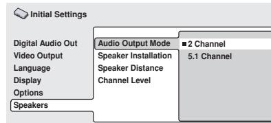
Если вы подсоединили этот проигрыватель к усилителю при помощи 5.1 канальных аналоговых выходов (передний, окружающий, центральный и басовый выходы), настройте эту установку на **5.1 Channel**; если вы подсоединили только стерео выходы, настройте на **2 Channel**.
