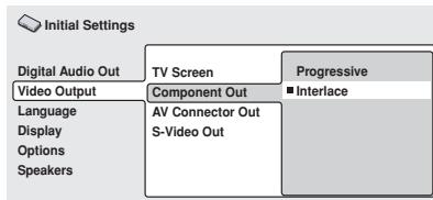
Если ваш ТВ совместим с поточным сканированием, выберите установку **Progressive** для того, чтобы видео воспроизводилось без мерцания. Если ваш ТВ не совместим с изображением с поточным сканированием, выберите установку **Interlace**. Свертесь с инструкцией по эксплуатации вашего ТВ, если вы не уверены в его совместимости.
