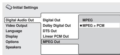
Если ваш AV приемник (или другой подсоединеный компонент) совместим с MPEG аудио, установите на **MPEG**, в обратном случае установите на **MPEG > PCM** (MPEG аудио конвертируется в более совместимое PCM аудио). Свертесь с инструкцией к вашему компоненту если вы не уверены, совместим ли он с MPEG аудио.
