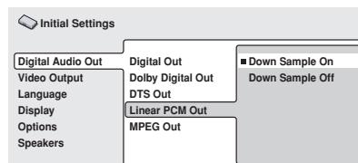
Если ваш AV приемник (или другой, подсоединеный, компонент) совместим с высокими частотами (96 кГ), выберите здесь **Down Sample Off**, в обратном случае выберите
