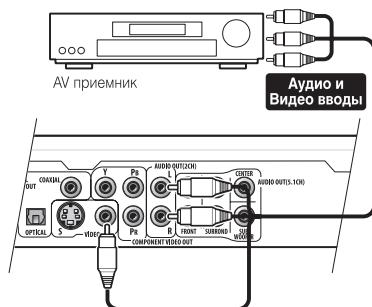
На схеме указаны стандартные видео соединения, но вы можете, также, использовать AV SCART типа, S-Видео или составные видео соединения, если имеется такая возможность.
