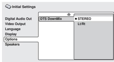
Если в главе *DTS Out (DTS выход)* на стр. 55 вы выбрали **DTS > PCM**, или **2 Channel** в главе *Audio Output Mode (Режим аудио выхода)* ниже, вы можете выбрать способ упрощения сигнала в PCM аудио. **STEREO** упростит DTS сигнал в 2 канальный стерео, а **Lt/Rt** упростит в 2 канальный сигнал, совместимый с декодерами матрицы Dolby окружения.
