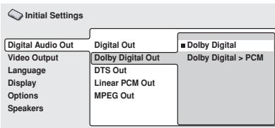
Если ваш AV приемник (или другой подсоединененный компонент) совместимый с Dolby Digital, установите на **Dolby Digital**, в обратном случае установите на **Dolby Digital > PCM**.
