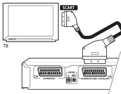
Этот соединитель может воспроизводить стандартное (составное), S-Видео или RGB компонентное видео. Установка по умолчанию - стандартная, которая должна срабатывать со всеми типами ТВ. Просмотрите инструкцию по эксплуатации к вашему ТВ, чтобы проверить, можете ли вы использовать какую-либо более качественную настройку. См. стр. 58, для подробностей об изменении видеовыхода.
