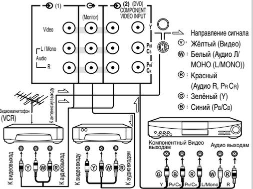
С терминалов (1) MONITOR выводится телевизионный или видеосигнал (1) или (2) или (3), который отображается на экране. Для записи телевизионного или видеосигнала подсоедините входные видео/аудиотерминалы видеомагнитофона к терминалам (1) MONITOR. В режиме DVD с терминалов (1) MONITOR выводится только сигнал "Y" (черно-белое изображение).
